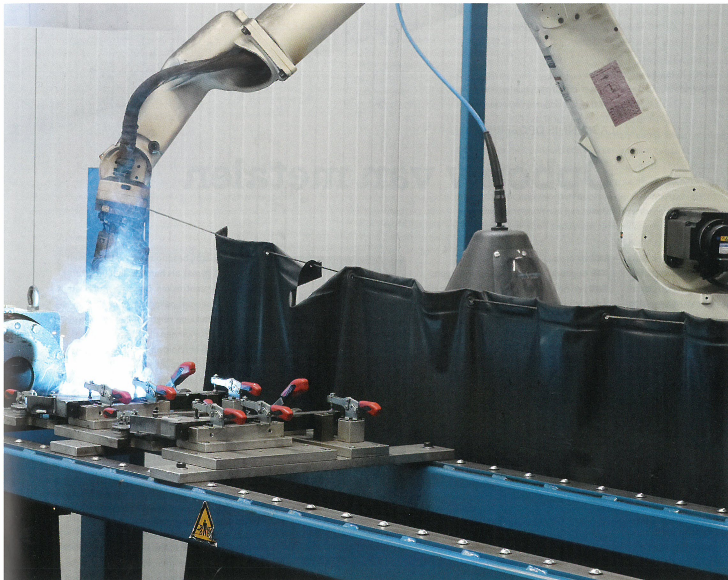
Voor het lassen met robot of cobots kan de werkwijze worden gevolgd die in de norm EN-ISO 15614-x staat.
