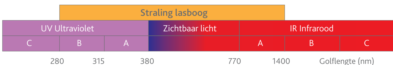
Figuur 3 - Uitgezonden straling van een lasboog
